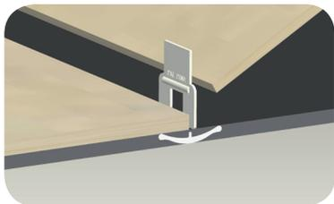
**1** Glisser le CLIPS blanc sous le bord du carreau à niveler. Puis poser le second carreau en butée contre le CLIPS, ou contre les croissillons d'écartement dans le cas d'un joint plus large.
