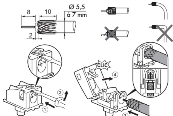
Utiliser du câble coaxial  $\varnothing 5,5$  à  $7$  mm -  $75 \Omega$
