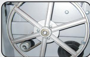
Volants en fonte d'aluminium (200 mm)
