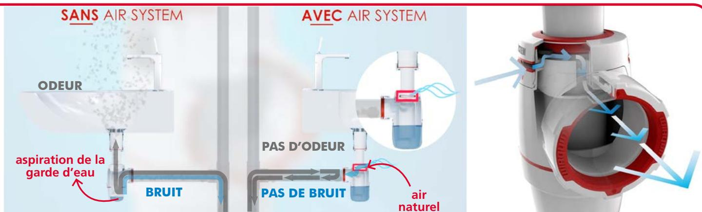
Quand une dépression est créée dans les tuyaux, cela aspire l'air mais aussi l'eau contenu dans le siphon (la garde d'eau).
