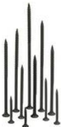
Vis autoperceuse à tête trompette et pointe clou pour fixation de plaques de plâtre Placo® sur ossature Placostil® ou sur ossature bois
